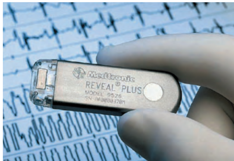
Abb. 2 Implantierbarer Loop-Rekorder (61 x 19 x 8 mm)
